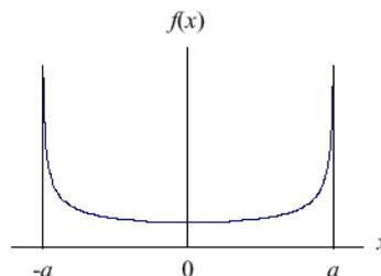
Esta distribuição encontra grande aplicação prática, por exemplo, nas medições em sistemas de rádio-frequências (RF), nos casos em que há desadaptações de impedâncias. Pode ser também utilizada para modelizar a distribuição de uma temperatura ambiente quando o controlo é efectuado pelo tradicional sistema “on/off”; contudo, não é habitual o recurso a esta distribuição nestas circunstâncias.
