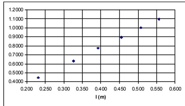
Como se observa, existe uma tendência linear na variação conjunta das duas grandezas. Vamos caracterizar essa dependência através de uma regressão linear simples. Pretende-se determinar a equação da recta  $y = m \cdot x + b$  (sendo  $y = \sqrt{M}$  e  $x = l$ ) que melhor aproxima o conjunto dos valores determinados experimentalmente, segundo o critério dos mínimos quadrados.
